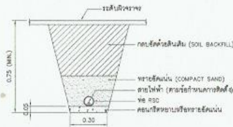
รายละเอียดการเดินสายไฟฟ้าใต้ผิวจราจร มาตราส่วน 1:20
